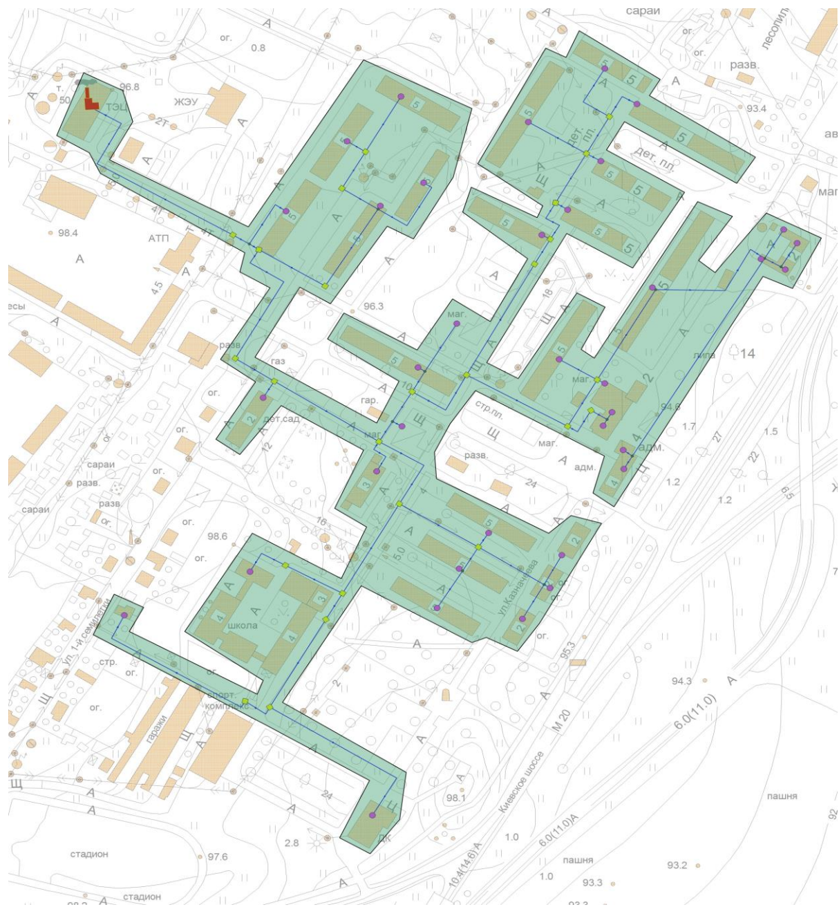
Рисунок 2.1. Зона действия котельной №9 дер. Большие Колпаны
